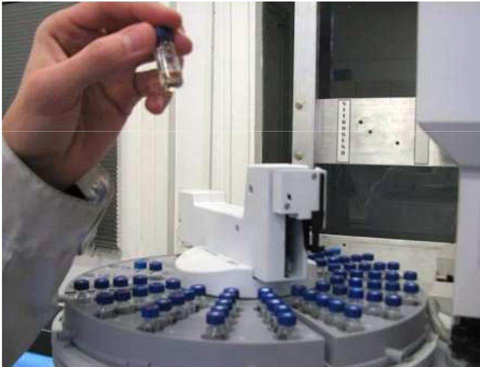
La composición de AG en la leche y los quesos se determinó por cromatografía gas-liquido, usando un cromatógrafo Agilent GC 6890 Serie Plus con detector FID y muestreador automático.
